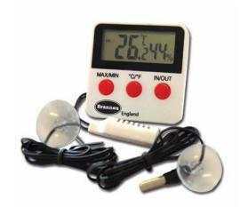
O termo higrómetro mede a temperatura e humidade do ambiente em que se encontra e a partir da sonda.
